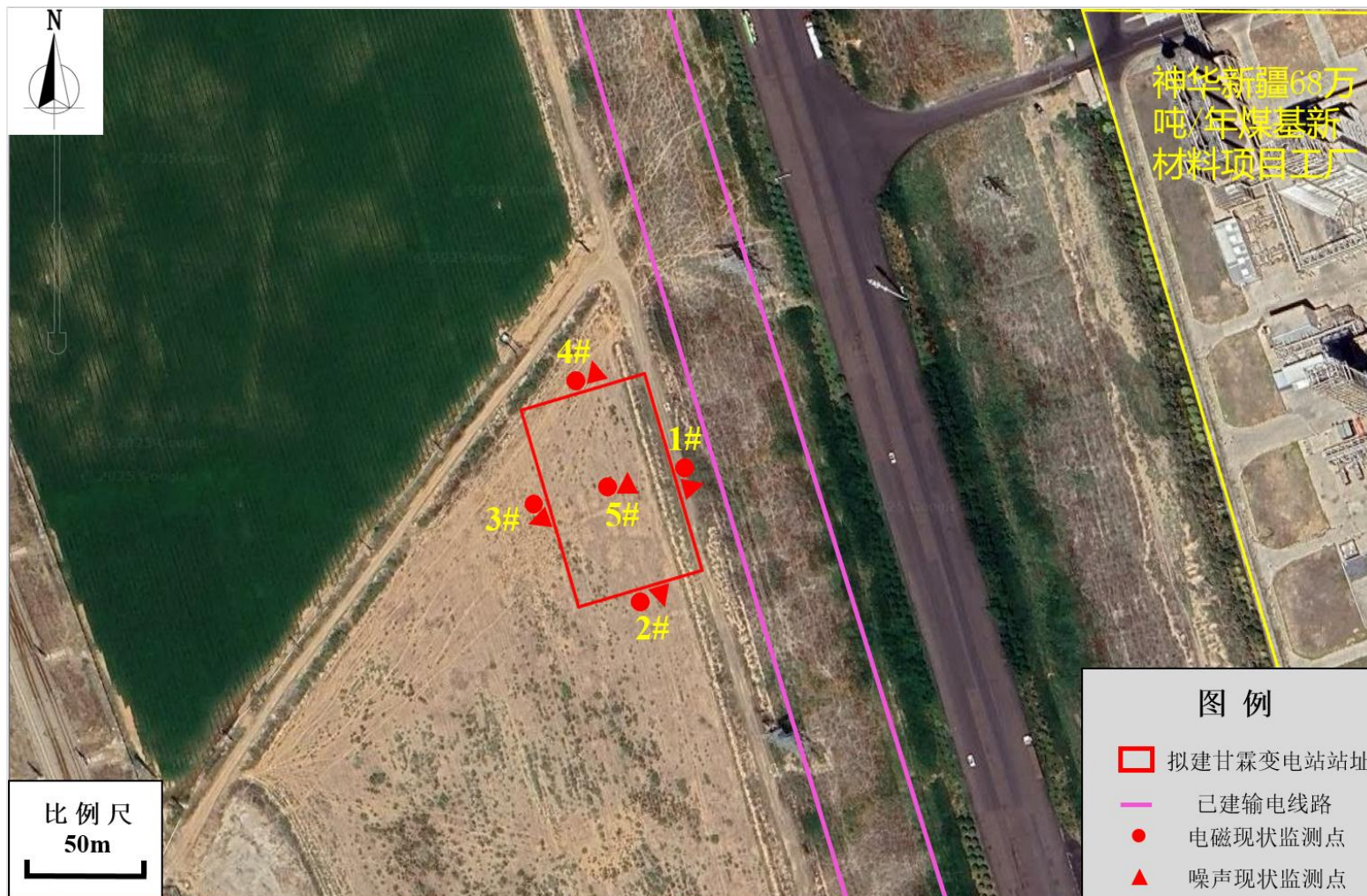
图 13 拟建甘霖 110kV 变电站站址监测点位示意图
