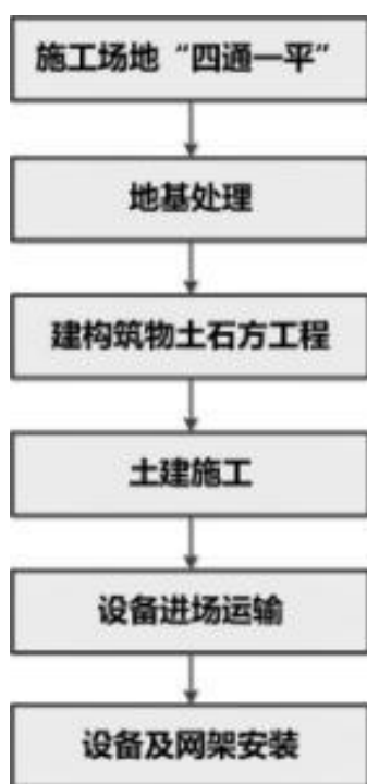
图 4 变电站工程施工工艺流程
