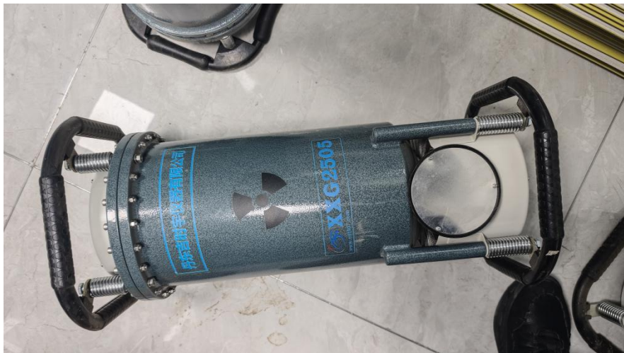
图 9-1 X 射线探伤机 X 射线管实物照片
