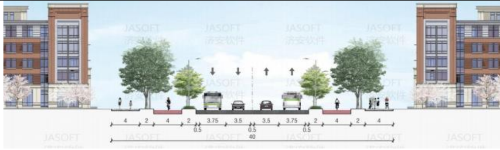
图 2-3 40 米宽次干路标准横断面图
