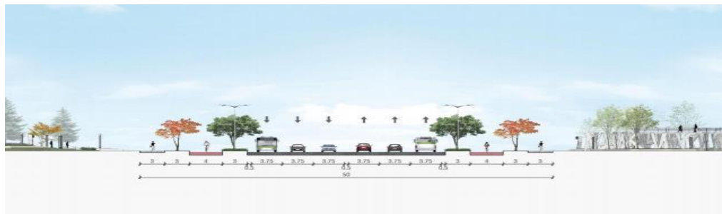
图 2-2 50 米宽主干路标准横断面图
