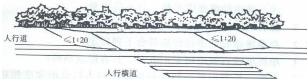
图 2-14 人行横道单面坡缘石坡道
